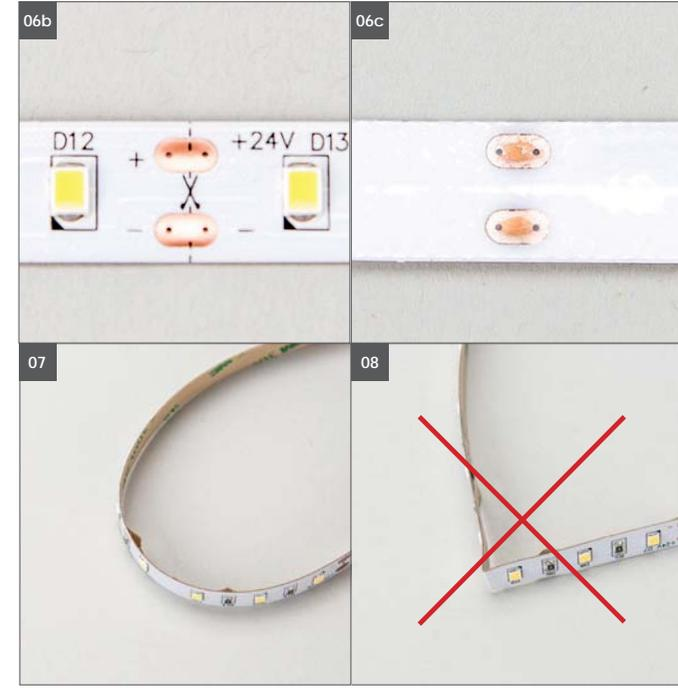
An den Lötstellen oben (**Bild 06b**) und unten (**Bild 06c**) miteinander verlöten. Lötstellen unten werden erst sichtbar wenn man die Schutzfolie abzieht. Bitte Schutzfolie nicht komplett abziehen, damit das FLEXY nicht die Klebkraft verliert! Achtung: Es dürfen an eine Einspeisung maximal 5 m Flexmodul gehängt werden, danach muss neu eingespeist werden.
