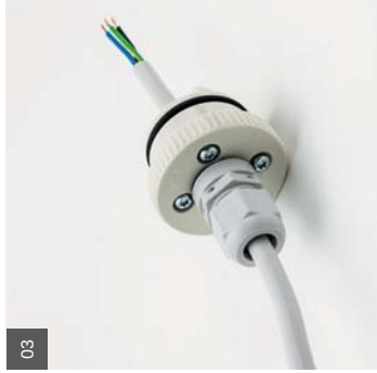
03. 3 x 1,5mm 2 Kabelende ca. 45mm abmanteln u. 10 mm absolieren, dann durchführen.
