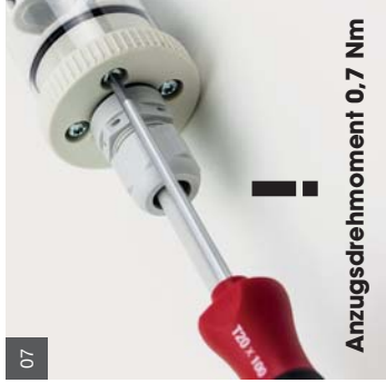
07. Enddeckel festhalten und Schrauben abwechselnd und gleichmäßig anziehen, bis sich der Deckel nicht mehr drehen läßt. Anzugsdrehmoment max. 0,7 Nm.
