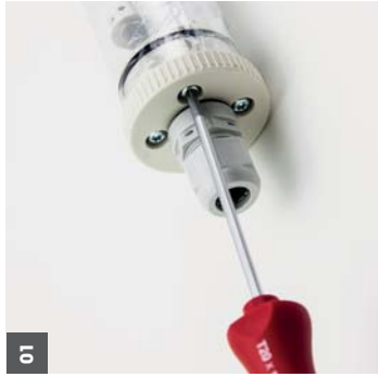
01. Enddeckel aufschrauben Torx T20. Verschlusskappe entfernen.
